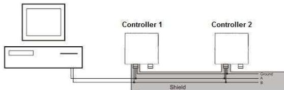
Экран кабеля RS-485 необходимо подключить к заземлению только с одной стороны (клетка 5 в версии 370 Вт, клетка 12 в версии 750 Вт).
