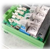
Модуль расширения / Датчики давления Плата управления – Control Circuit Адрес 18
