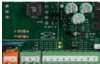
В левой нижней части контроллера расположены два светодиодных индикатора.
