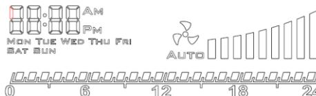
W czasie kiedy sterownik jest włączony, dłuższe przytrzymanie przycisku [Set] (ok. 5 sekund) otworzy funkcję programowania tygodniowego. Przejście do kolejnej nastawy następuje po naciśnięciu klawisza [^]. Zmiany wartości poszczególnych nastaw wykonuje się przy użyciu przycisków [Set] oraz [^] i [v].
