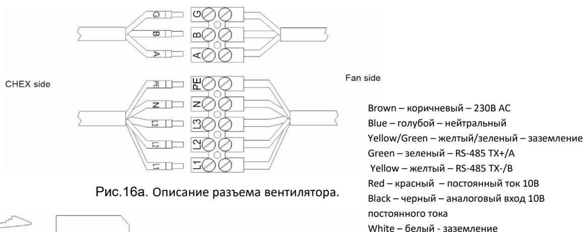
Рис.16а. Описание разъема вентилятора.
