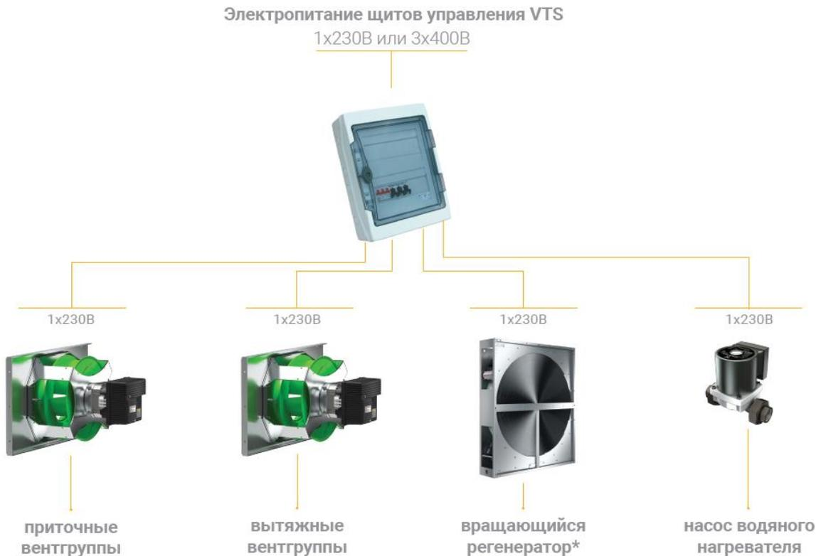
*\*) до типоразмера VVS300 вращающийся регенератор оснащен ЕС-двигателем, для типоразмеров VVS400 и выше вращение теплообменника осуществляется при помощи АС-двигателя с преобразователем частоты.*
