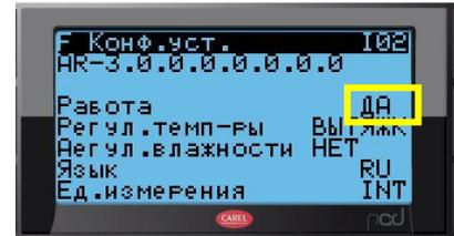
На этом экране мы также выбираем, какой датчик температуры является главным (ведущим) – смонтированный в канале вытяжного или в приточного воздуха («Регул. темп-ры»), также может быть активирован контроль влажности активировать контроль влажности («Регул. влажности»), выбрать язык для сервисного меню («Язык») и единицы измерения «Ед. Изм». Каждое изменение подтверждается нажатием кнопки «Enter».
