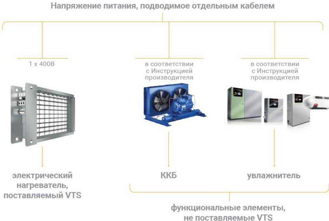
**Рис. 2** Элементы требующие отдельного подключения электропитания
