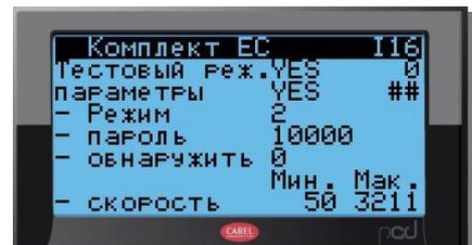
Правильно запрограммированный двигатель выключаем и включаем двигатель следующего приточного вентилятора. Возвращаемся к экрану «I15», устанавливаем адрес этого двигателя, в нашем примере адрес 5 и снова включаем автоматическое программирование. Повторяем процедуру для всех двигателей, не забывая устанавливать правильные адреса.
