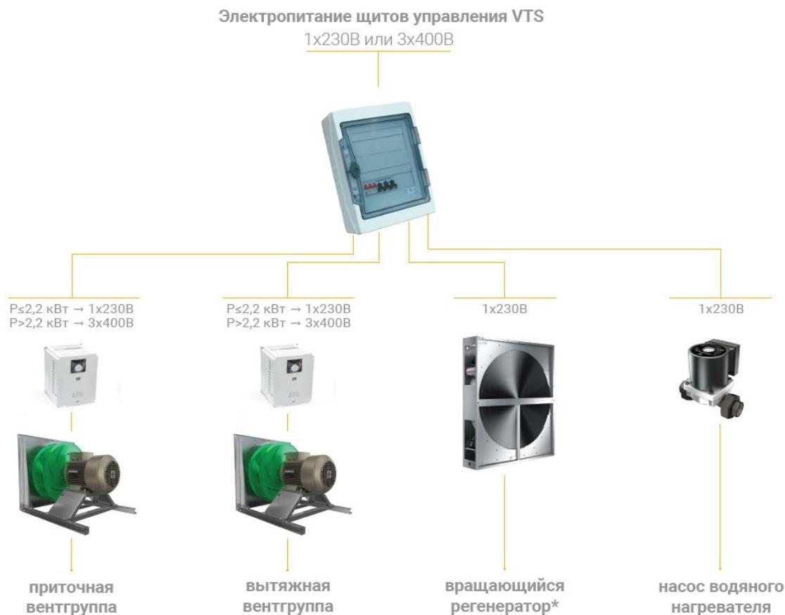
*\*) до типоразмера VVS300 вращающийся регенератор оснащен ЕС-двигателем, для типоразмеров VVS400 и выше вращение теплообменника осуществляется при помощи АС-двигателя с преобразователем частоты.*
