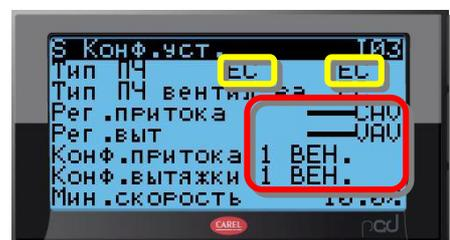
Настройку начинаем с экрана „I03”, где устанавливаем тип двигателей для вентиляторных групп приточных и вытяжных. На этом же экране в последующих строках устанавливаем тип регулирования (CAV, VAV или NET – постоянная частота), а также количество приточных и вытяжных вентиляторных групп.
