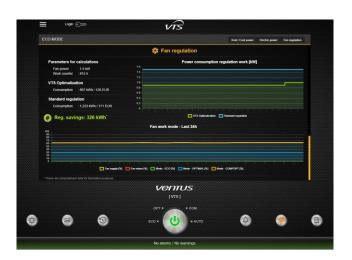
На правильность отображаемых данных влияет правильная установка всех датчиков. Рекомендуется для AHU с функцией CAV и для AHU с дополнительным датчиком после рекуперации. Все двигатели должны иметь связь по Modbus для считывания электрических данных.
