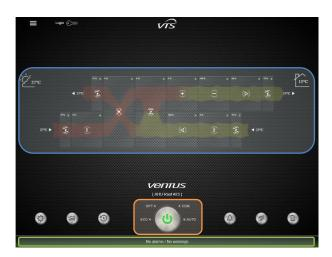
Нажатие на данный раздел панели управления отображает предварительный просмотр текущих параметров данного устройства.
