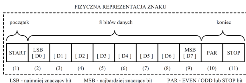
Рис. 8. Символьный формат в стандарте MODBUS RTU, используемый в преобразователе.
