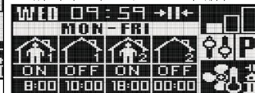
Пример запрограммированного календаря (рабочие дни). Завеса будет включена в 8 часов утра и она будет выключена в 10 часов утра. Новое включение будет в 6 часов вечера, отключение в 00:00. Цикл будет повторяться с понедельника по пятницу.
