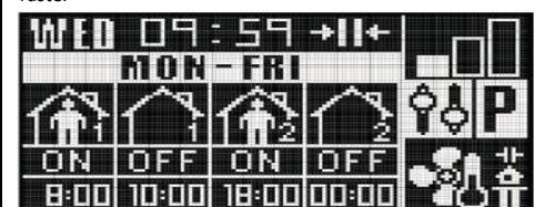
Ein Beispiel von Programmierung des Kalenders (Arbeitstage). Einschaltung des Gerätes erfolgt um 8.00 Uhr, Abstellung um 10:00 Uhr. Weitere Betriebsaufnahme erfolgt um 18:00 Uhr, und die Abstellung erfolgt um 00:00 Uhr. Dieser Zyklus wird von Montag bis Freitag wiederholt.
