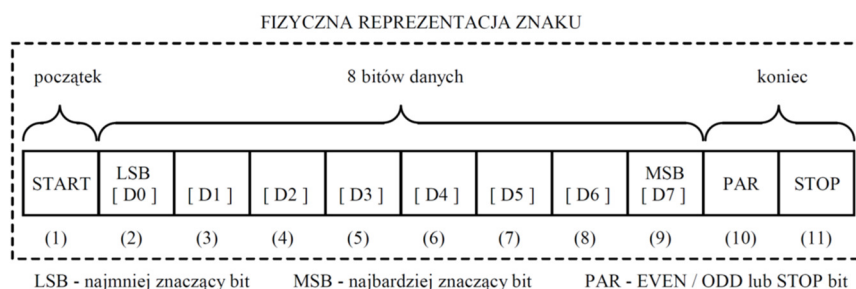
Rysunek 8. Format znaku w standardzie MODBUS RTU zastosowany w przetworniku.
